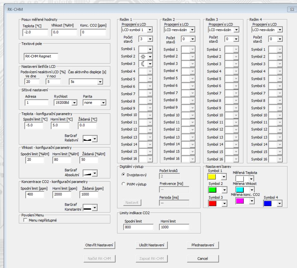
Kliknutím na tlačítko "Načíst RK-CHM-D" se vyčtou konfigurační hodnoty z flash paměti snímače.
