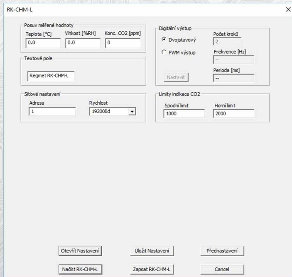
Kliknutím na tlačítko "Načíst RK-CHM-L" se vyčtou konfigurační hodnoty z flash paměti snímače.
